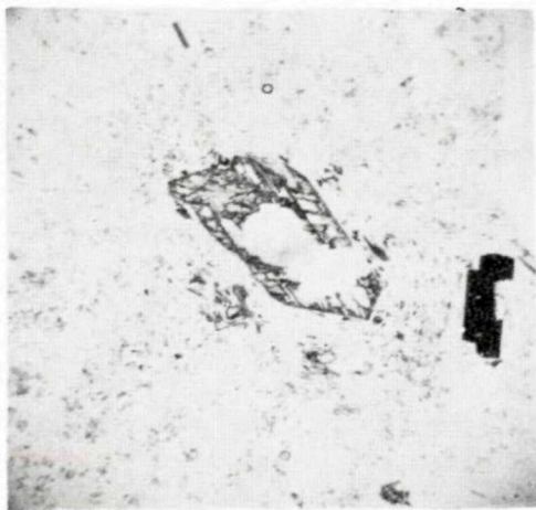
Obr. 1. Hyalinno-pórovitá štruktúra základnej hmoty so zvyškom výrastlice amfibolu. // N, zv. 31,5×. Lehôtka pod Brehy. Foto L. Osvald
